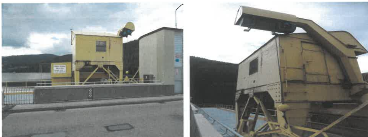
Zdjęcie 26, 27. Czyszczarka krat wlotowych i jej charakterystyczne wyposażenie dźwigowo – transportowe
